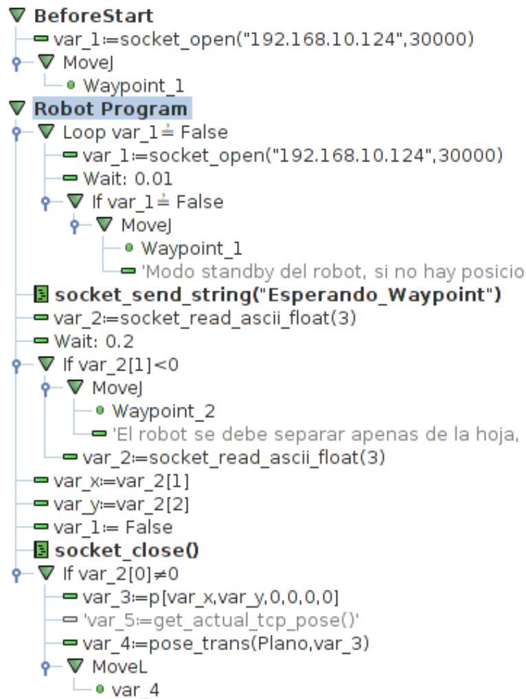
Figuras 4.1 Código de PolyScope encargado de ejecutar las posiciones obtenidas con el eye tracker.
